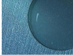
Resim 4.3. Soldaki taklit malzeme, kılıf yüzeyi daha pürüzlü ve deforme.
