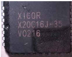
Resim 4.5. Taklit malzeme, kimyasal ile adı siliniyor.
