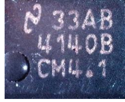
Resim 4.2. Taklit malzemeler; yazıları net değil, silik veya deforme olmuş.
