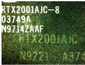
Resim 4.1. Altında orijinal yazısı silinip, yeniden isimlendirilmiş taklit veya kullanılmış malzeme.
