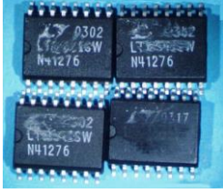
Resim 4.2. Taklit malzemeler; yazıları net değil, silik veya deforme olmuş.
