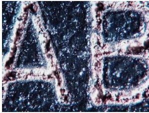
Resim 4.4. Laser ile üzeri kötü yazılmış taklit malzeme.
